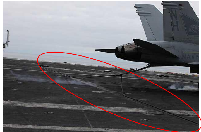
図2.アレスティングワイヤー（戦闘機にはワイヤーをひっかけるためのフックが付いている）
